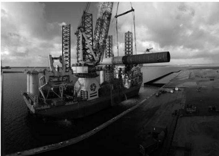
**Abb. 7.75** Jack-up-Schiff beim Heben eines Monopiles.
