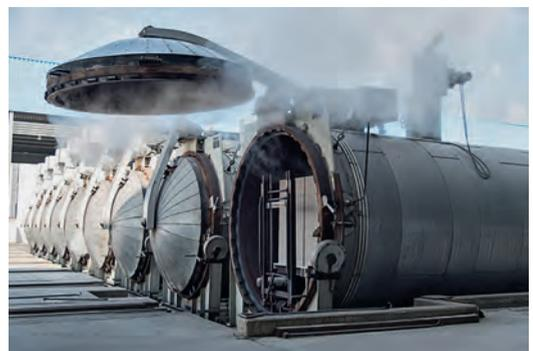
**Bild 2.** Produktion – Härtekessel (Quelle: Bundesverband Kalksandsteinindustrie e. V.)
