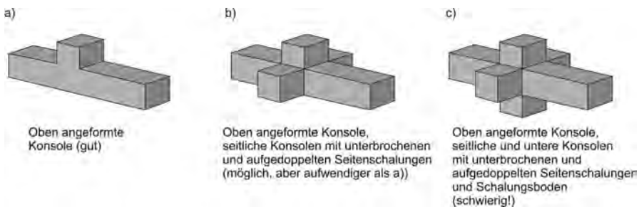
Abb. 2.11 Liegend hergestellte Stützen; a) mit oberseitiger Konsole, b) mit dreiseitigen Konsolen, c) mit vierseitigen Konsolen.
