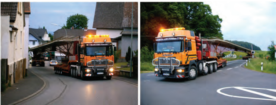
Abb. 2.15 Transport eines Brückenträgers.
