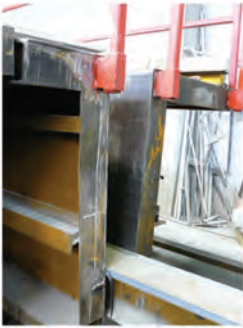
Abb. 2.10 Schalung einer TT-Platte.
