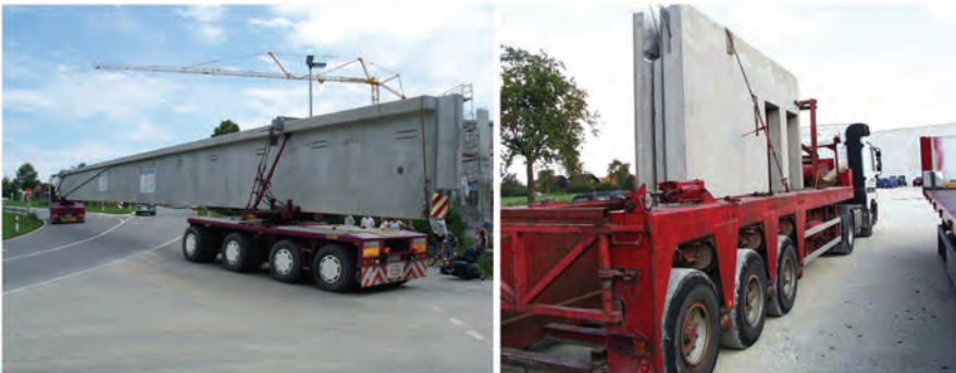
Abb. 2.14 a) Zugmaschine mit Nachläufer, b) Innenlader.
