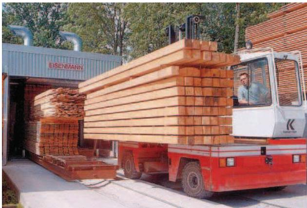
**Bild 9-8** Beschickung einer Trockenkammer mit Bauholz. Ein Gleiswagen wird durch einen Seitenstapler beladen (Bild: EISENMANN)
