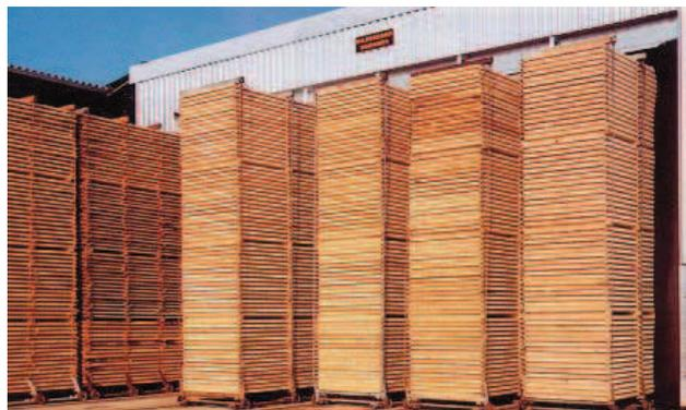
**Bild 9-7** Beschickungsseite eines großen Trockenkanals mit Längsanordnung der Stapel, kontinuierlich gefördert auf Rollenböcken (Bild: BRUNNER-HILDEBRAND)
