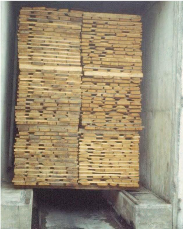
**Bild 9-10** Stapel sind durch einen Hubwagen auf zwei Mauerbänken in der Kammer abgestellt worden
