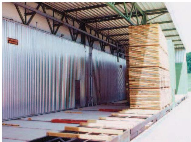
**Bild 9-9** Einfahrseite eines Trockenkanals mit Querförderung. Die Stapel werden auf Gleiswagen bewegt, deren Spurräder quer montiert sind. Die Wagen klinken in Drahtseilzüge ein
