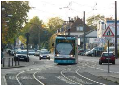
Bild 2.1 Wirkung der Fliehkraft im Kreisbogen ohne Überhöhung
