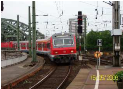
Bild 2.4 Fahrt in überhöhtem Kreisbogen, Überhöhung \leq 100 mm
