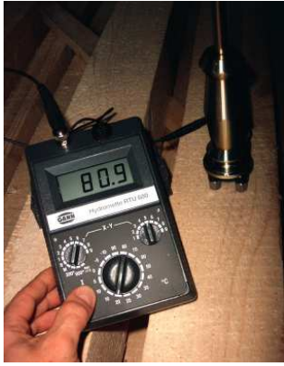
Bild 1-94: Feuchtemessung an sehr feuchtem Bauholz
