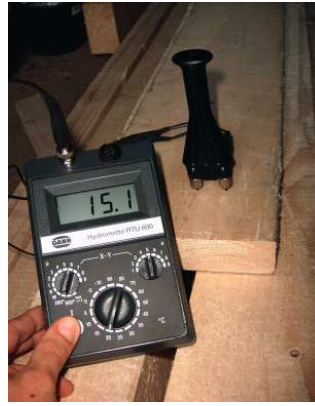
Bild 1-95: Feuchtemessung an trockenem Bauholz
