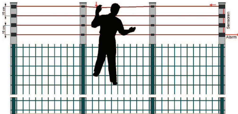
Abb. 4.2.1: Prinzip einer Drahtzugmeldeanlage
