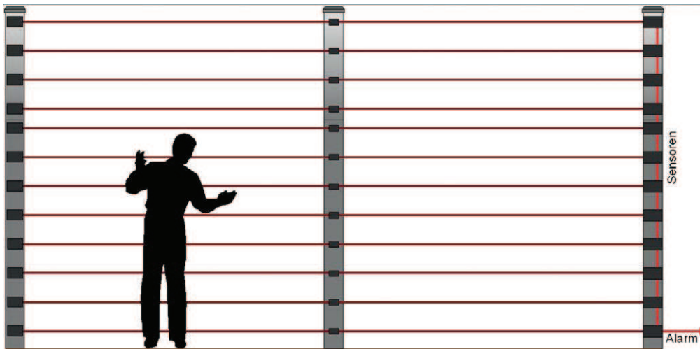
Abb. 4.2.2: Spanndrahtsystem als eigenständige Barriere
