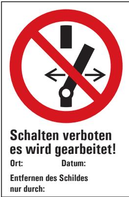
Bild 7.3 Verbotsschild „Schalten verboten“ mit Zusatztext
