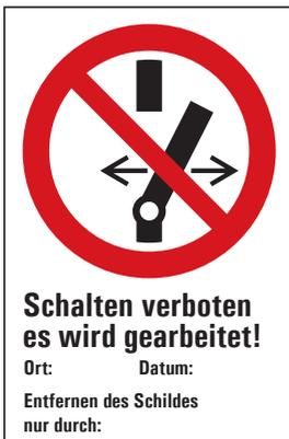
**Bild 7.10** Verbotsschild „Schalten verboten“ mit Zusatztext
