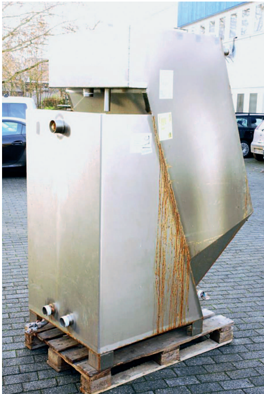
Der geschädigte Schrägklärer einer Abwasserbehandlungsanlage mit deutlichen Korrosionsschäden.
