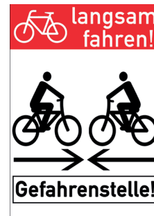
Bild 14: Hinweistafel Gefahrenstelle (Quelle: Handbuch zur Radwegweisung in Hessen, HMWEVL)
