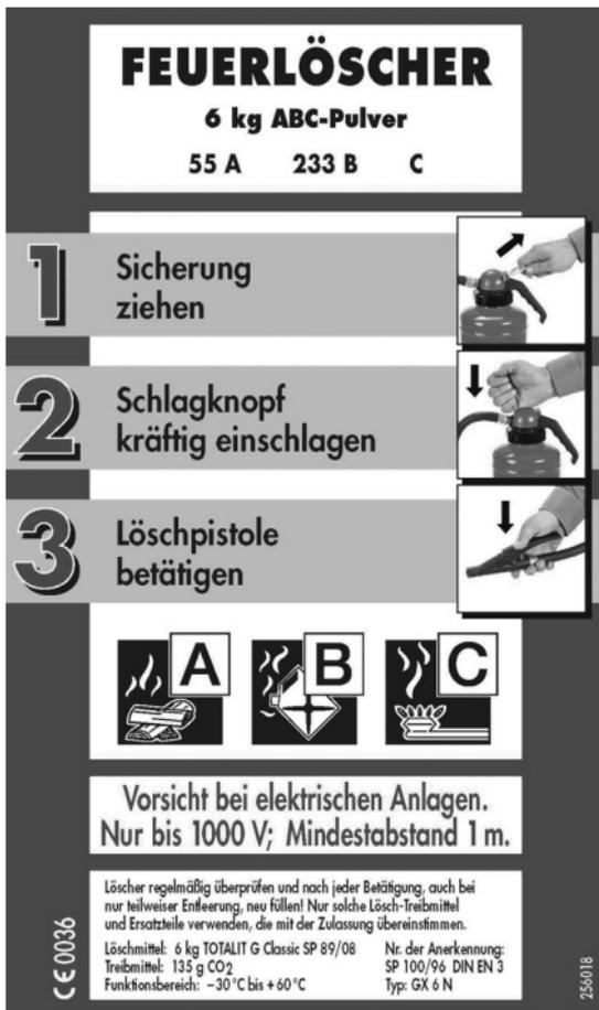
**Bild 2:** Beispiel einer Kennzeichnung auf einem Feuerlöscher
